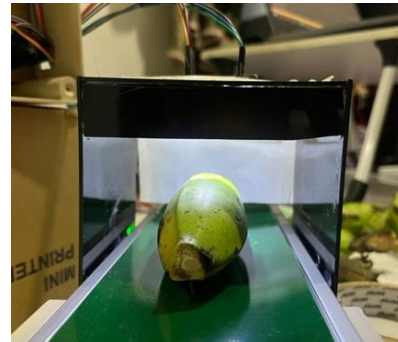
Gambar 3.1. Penempatan Buah Pisang saat Kalibrasi
