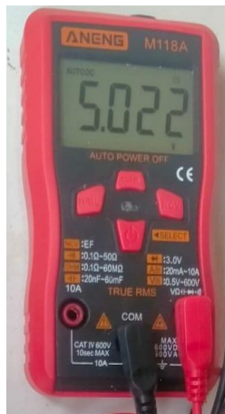
Gambar 18. Hasil Pengukuran Tegangan di Output Sensor Resistif
