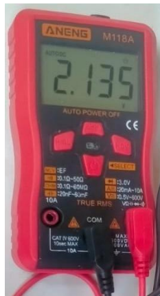
Gambar 19. Hasil Pengukuran Tegangan di Output Sensor Kapasitif
