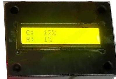
Gambar 20. Tampilan Hasil Pengukuran Kadar Air Beras pada LCD 16 x 2
