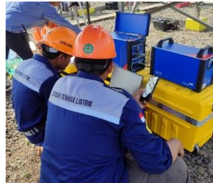
Gambar 5. Pengujian tan delta dan kapasitansi
