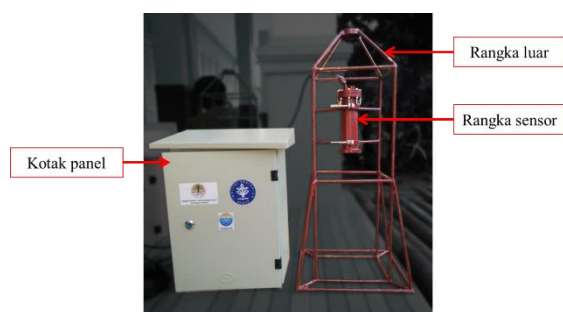
Gambar 6 Hasil rancang bangun instrumen pendeteksi gelombang permukaan laut
