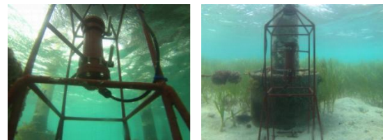
Gambar 9 Peletakan instrumen pendeteksi gelombang permukaan laut di perairan Pulau Pramuka
