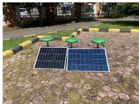
Gambar 3. Panel Surya Polikristalin dan Monokristalin.
