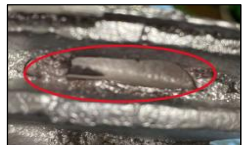
Gambar 12. Perbandingan cacat misrun hasil simulasi dan aktual
