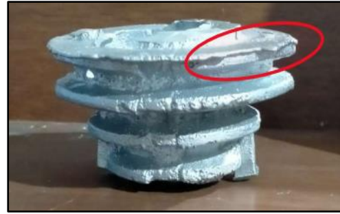
Gambar 10. Perbandingan cacat fin hasil simulasi dan aktual
