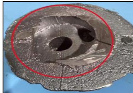
Gambar 13. Perbandingan posisi core pada simulasi dan aktual
