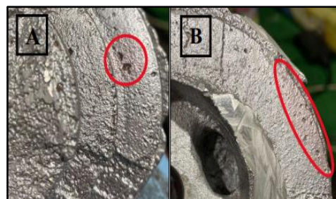
Gambar 9. Perbandingan gas defect hasil simulasi dan aktual
