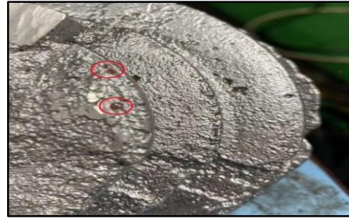
Gambar 15. Perbandingan cacat sand inclusion hasil simulasi dan aktual
