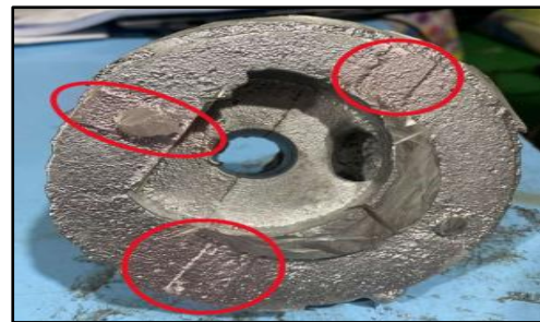
Gambar 11. Perbandingan cacat shift hasil simulasi dan aktual
