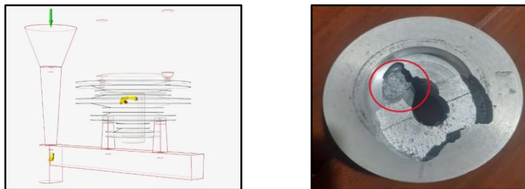
Gambar 6. Perbandingan porositas hasil simulasi dan aktual
