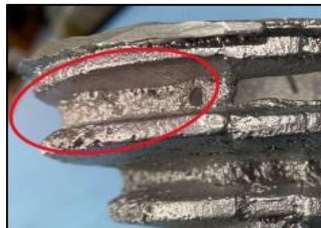
Gambar 14. Perbandingan cacat swell hasil simulasi dan aktual
